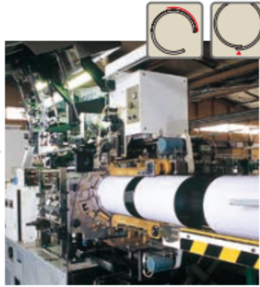
②③ロールフォーミング&シーム溶接機 (円筒成形・シーム溶接)
